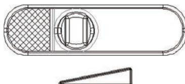
Pro minimální výkon regulátor primárního vzduchu úplně uzavřete, a pokud máte v kouřovodě zabudovanou záklopku, přivřete jí.
