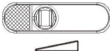
Für die Mindestleitung Primärluftregler ganz schließen. Inwiefern in dem Abgaskanal ein Schließdeckel eingebaut ist, müssen Sie diesen schließen.
